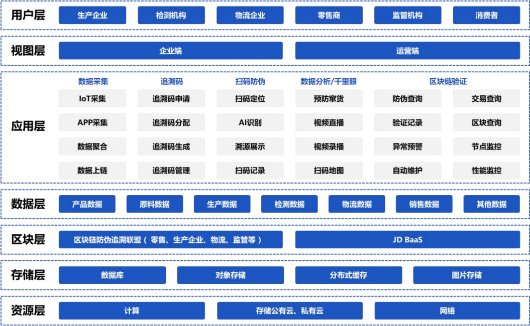
图 48 智臻链防伪追溯平台架构图
