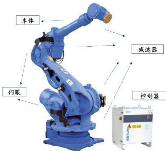
图 16：电机在工业机器人当中的位置
