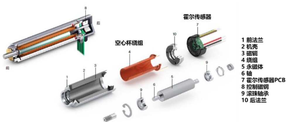
图 13：空心杯电机及其构成示意图
