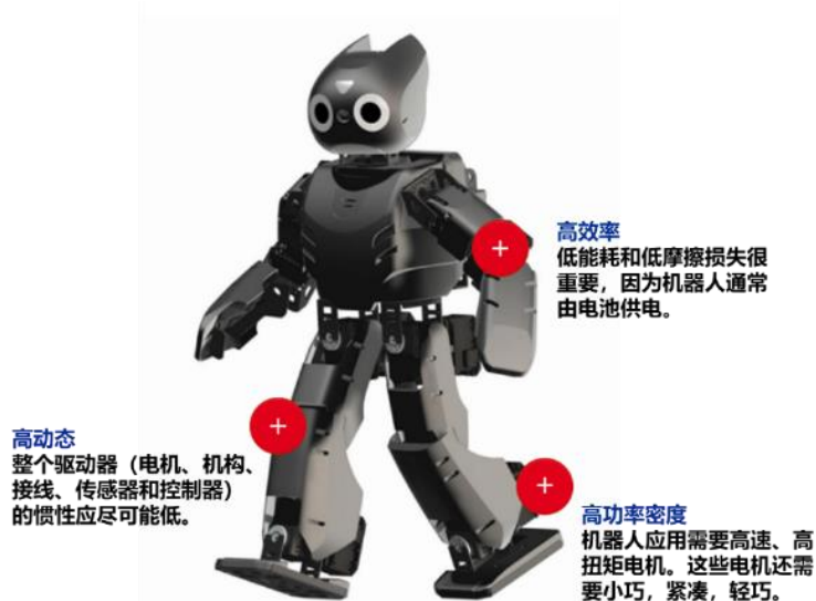
图 20：机器人电机侧重三点：高效率、高动态和高功率密度
