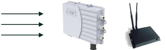
ZETA网关用于接收来自ZETag的数据并将其上传到服务器。通过在关键节点中合理部署网关，ZETag可以实现不同的功能。
